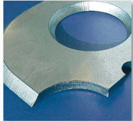
Beispiel: V-Innenkante 30° V-Außenkante 40° Material: Baustahl 8 mm
